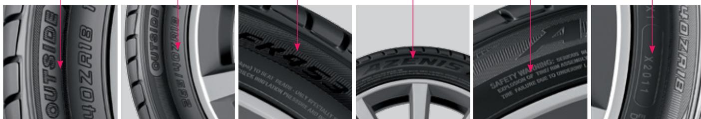
Indicatore di montaggio del pneumatico
